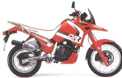
**Motor:** Luft/Ölgekühlter 1-Zylinder 4-Takt-Motor, Hubraum: 779 cm<sup>3</sup>, Bohrung x Hub: 105 x 90 mm, Verdichtung: 9,5:1, 37 kW (50 PS) bei 6.400 min<sup>-1</sup>, bzw. 20 kW (27 PS) bei 5.800 min<sup>-1</sup>, 59 Nm / 5.500 min<sup>-1</sup>, 52 Nm bei 2.500 min<sup>-1</sup>, OHC, 4 Ventile pro Zylinder, 2 Mikuni BST 33 Vergaser, Elektrostarter, Druckumlauf-Schmierung mit Ölkuhler
