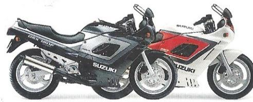
**Motor:** Luft/Ölgekühlter 4-Zylinder, 4-Takt-Motor in Reihe, Hubraum: 748 ccm, Bohrung x Hub: 73 x 44,72 mm, Verdichtung: 10,7 : 1, 74 kW (100 PS) bei 10.400 min<sup>-1</sup>, max. Drehmoment: 70,6 Nm bei 9.800 min<sup>-1</sup>, DOHC, 4 Mikuni BST 36 Slingshot-Vergaser, Trockenluftfilter, Elektrostarter, Naßsumpf-Druckumlaufschmierung mit zwei Ölumpen
