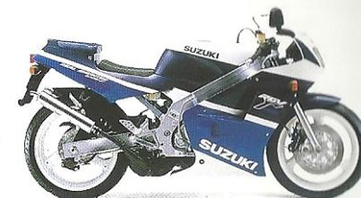
**Motor:** Wassergekühlter 2-Zylinder 2-Takt, V-Motor (90°), Hubraum: 249 cm<sup>3</sup>, Bohrung x Hub: 56,0 x 50,6 mm, Nennleistung: 58 PS (42,9 kW) bei 11.000 min<sup>-1</sup>, max. Drehmoment: 38 Nm/10.800 U/min<sup>-1</sup>, Gassteuerung: Membrane, 2 Mikuni VM 32SS, Kickstarter, Schmiersystem: CCI-System.
