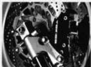
Schwimmend gelagerte 4-Kolben-Doppelscheiben, \varnothing 300 mm.
