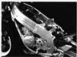
Der verwendungssteife Delta-Box-Aluminiumrahmen mit abschraubbaren Unterzügen.
