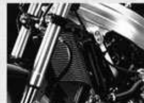
Halbrunde Kühlerform für größere Kühlfäche.
