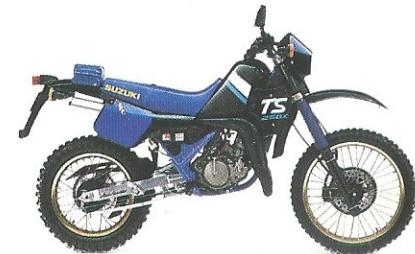
**Motor:** Flüssigkeitsgekühlter 2-Takt, 1-Zylinder, Hubraum: 249 cm<sup>3</sup>, Bohrung x Hub: 70 x 64,8, Verdichtung: 7,4 : 1, 27 PS (20 kW) bei 8.200 min<sup>-1</sup>, max. Drehmoment: 27 Nm/5.000 min<sup>-1</sup>, Gassteuerung: Membrane, Mikuni VM 32 Vergaser, Kickstarter, Frischölschmierung.
