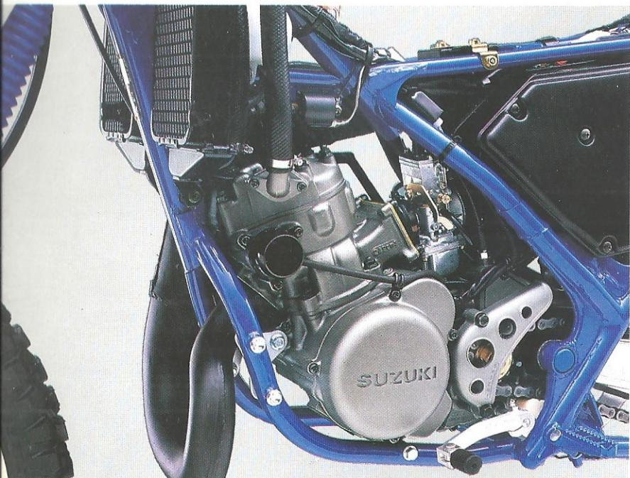
Flachschieber-Vergaser, Membran-Einlaß und Auslaß-Steuerung: bissig, elastisch und durchzugsstark. „Der Dampf der TS 250 X läßt Cross-Pisten mit Freude meistern, und für die Straße reichen Beschleunigung und Spitze allemal.“ (MOTORRAD TEST/88)
